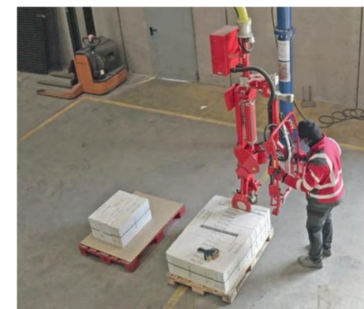
◀ Robô para a movimentação de cerâmica. Trata-se de uma máquina de elevação e acionamento pneumático que facilita a elevação e a descida da carga, com possibilidade de translação tanto horizontal como vertical.
